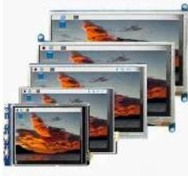
[그림2] 완성품 제품이 아닌 부품용 소형 디스플레이 크기가 큰 대형 디스플레이로 관객을 몰입시키는 방식 대신 거울을 이용하여 해당 경험요소를 대체하고 사용되는 디스플레이는 2~11인치의 비교적 저렴한 무터치 LED 컬러 디스플레이를 활용한다.
