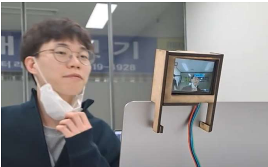
[그림3] 시청자의 얼굴을 추적하여 인식하는 허스키 렌즈 인공지능을 적용하여 관객이 있을 때만 연출이 재생되거나 관객의 얼굴을 추적하며 맞춤형 시야를 제공하거나 관객의 프로필을 분석하여 맞춤형 콘텐츠를 재생하기까지 다양한 기능을 제공할 수 있지만, 많은 기능을 제공할수록 고성능의 하드웨어가 필요하고 이는 곧 비용의 증가로 이어짐으로 본 연구의 목적과는 부합하지 않는다.
